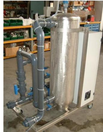
Il sistema GEOMIX è provvisto di essiccatore aria, idoneo a fornire la quantità e la qualità di aria compressa al generatore d'ozono.
